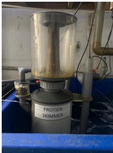
Penyiring protein yang digunakan di AkuaTAR
