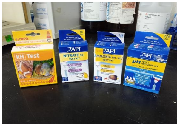
Jenis kit bagi tujuan pengujian kualiti air yang digunakan di AkuaTAR
