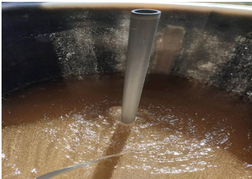
Tangki ternakan Artemia yang berbentuk kon dengan kapasiti 100 liter
