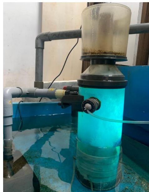
Penyiring protein yang digunakan di AkuaTAR
