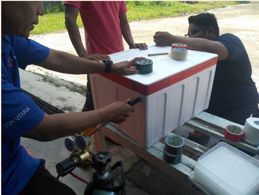
Gambar: Gas oksigen tulen dimasukkan ke dalam kotak Styrofoam melalui lubang yang dibuat.
