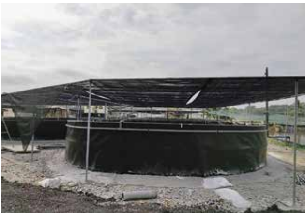
Tangki bulat HDPE berkapasiti 100 m 3
