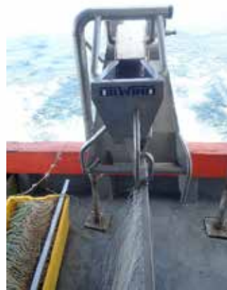
Peralatan Automatik Rawai Laut Dalam ABLL. ABLL fishing gear.
