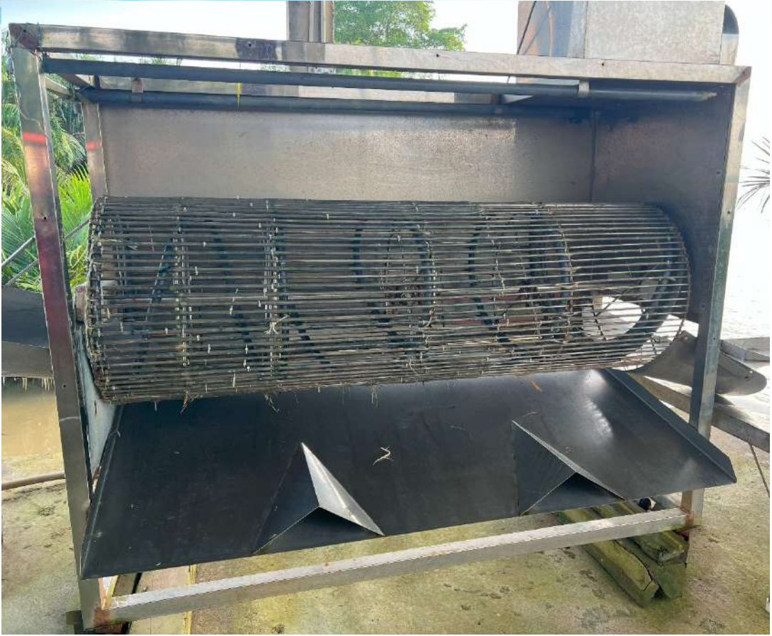
Gambar 59: Mesin penggredan kerang yang dibekalkan kepada Projek Kebun Kerang terpilih.
