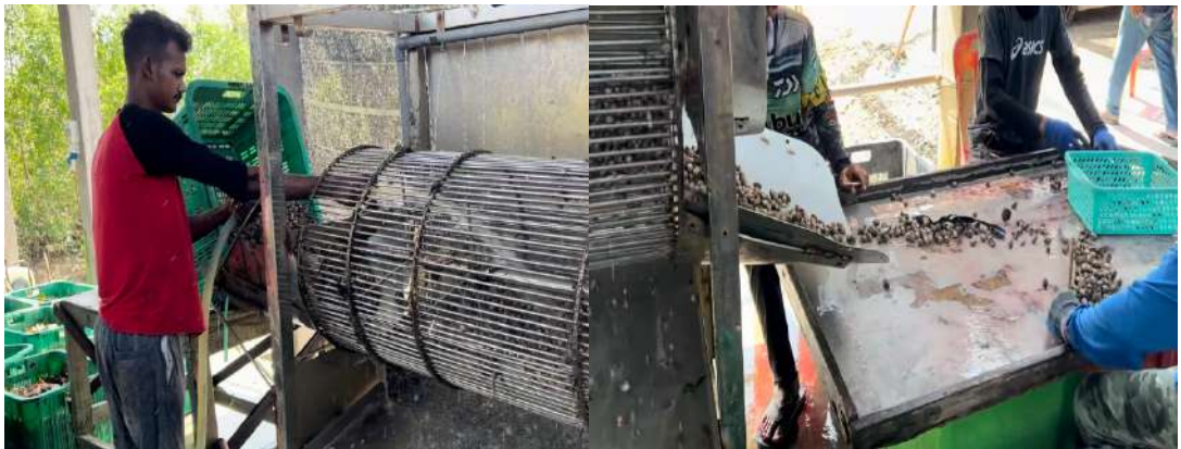
Gambar 60: Kerang kasar dituangkan ke dalam dram bagi tujuan pembersihan kerang. Kulit kerang dan kerang bersaiz kecil akan terlepas di sisi dram, manakala kerang dewasa yang bersih akan asingkan di bahagian hadapan.
