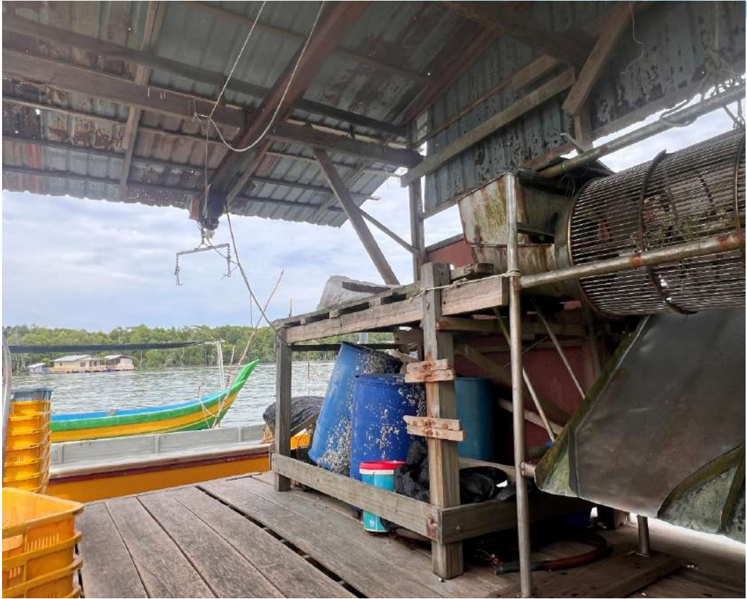
Gambar 52: Alat mengangkat (Kren) digunakan bagi mengangkat bakul berisi kerang dewasa sekitar 100 kg setiap satu ke atas pelantar pengasingan saiz kerang.
