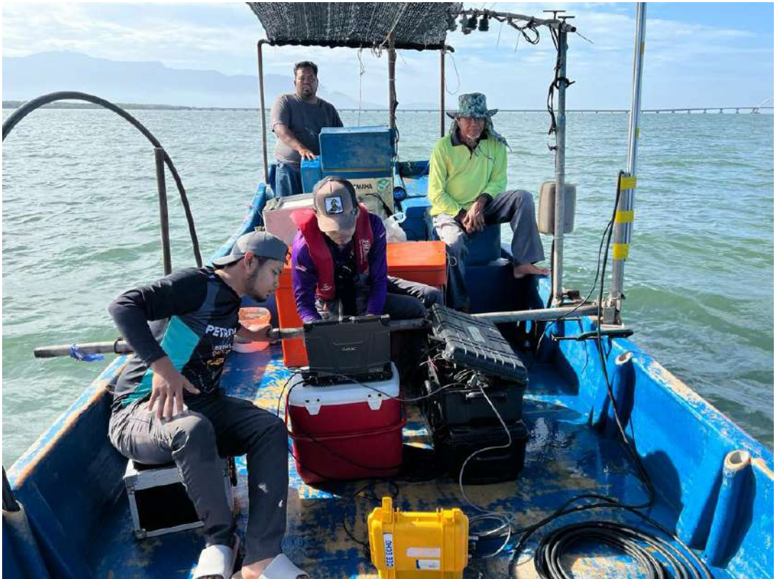
Gambar 82: Aktiviti pengemaan bunyi untuk kajian Batimetri. Kajian ini akan memaparkan kedalaman air dan ketebalan lumpur di kawasan kajian.
