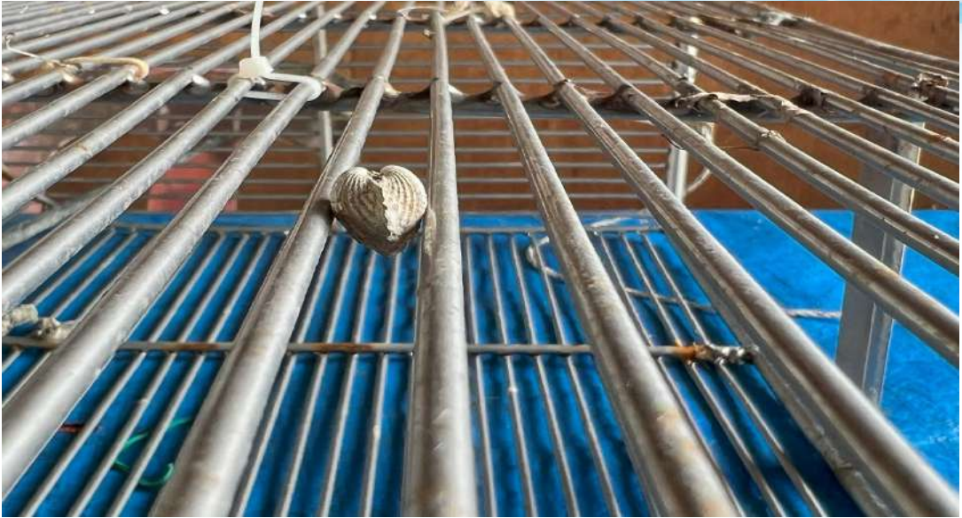
Gambar 27: Saiz mata bertujuan untuk memerangkap kerang bersaiz tertentu.
