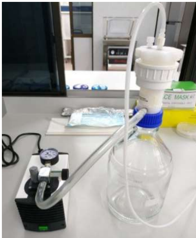
Gambar 5: Air laut disterilkan menggunakan Pam Vakum Mini Microsart (Sartorius) dan melalui penapis cakera kaca gentian mikro (Bioflow).
