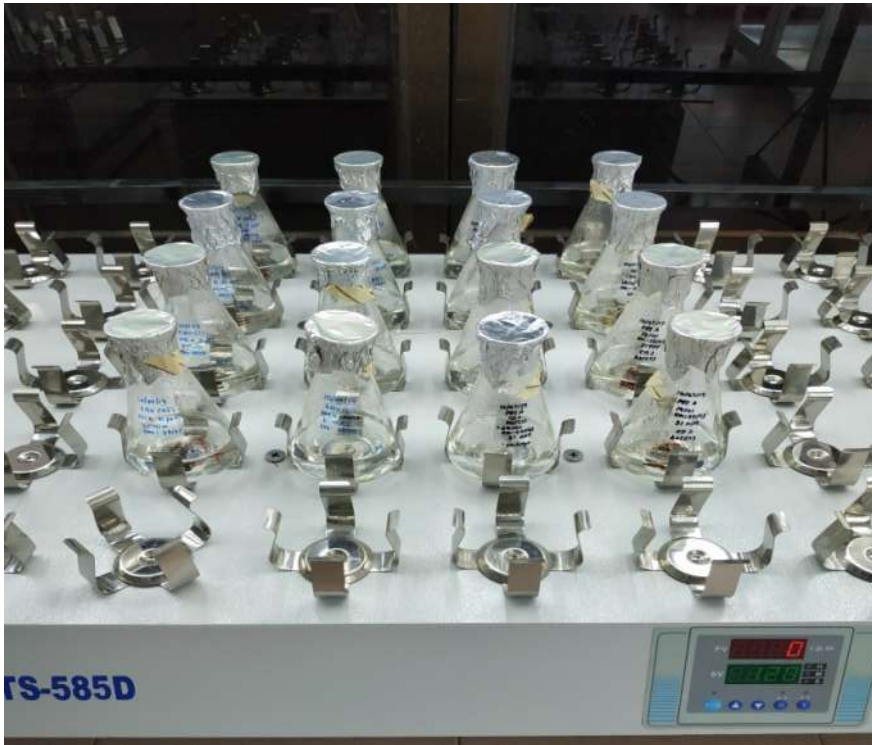
Gambar 11: Kelalang kon diletakkan di atas orbital shaker dengan kelajuan putaran 120 rpm dalam keadaan pada suhu 23°C. Kitaran lampu dipasang dan ditutup selama 12:12 jam dibawah sinaran 1000 – 2000 lux (lampu putih).
