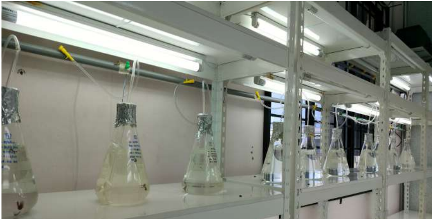
Gambar 13: Kelalang kon 1L diletakkan di atas rak dalam bilik kultur pada suhu 23°C, kitaran lampu dipasang dan ditutup selama 12:12 jam dibawah sinaran 1000 – 2000 lux (lampu putih).
