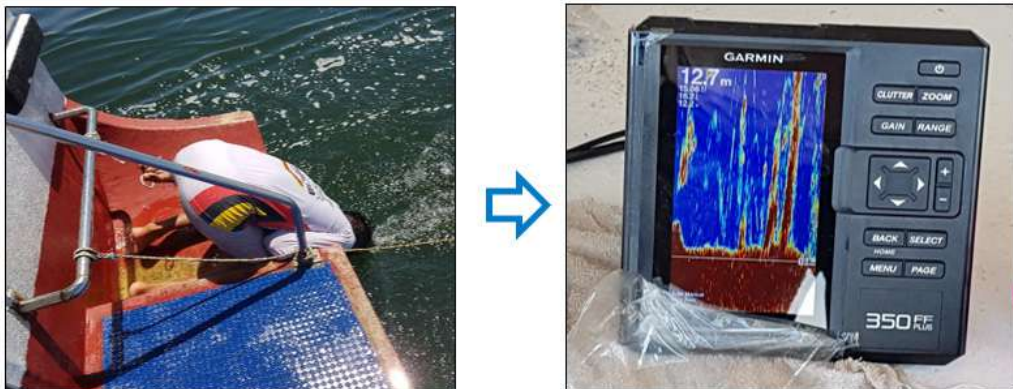
Rajah 1: Penambahbaikan teknik meninjau kehadiran ikan dengan menggunakan peralatan elektronik pencari ikan
