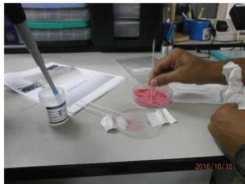
Proses menutup bahagian hujung straw menggunakan serbuk PVC yang dibasahkan.
