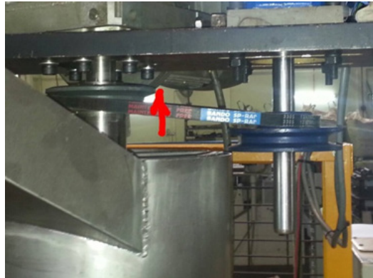
Terdapat isu penolakan skrew ke belakang yang menyebabkan lubang ceper tersumbat akibat kehilangan tekanan
