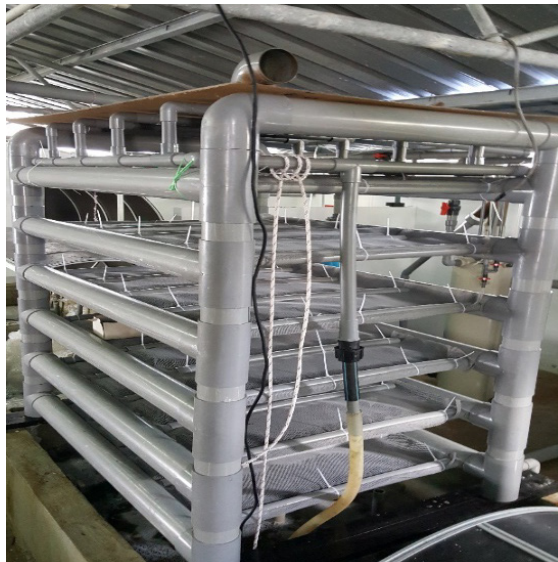
DEGAZER TD bertujuan penyingkiran gas karbon dioksida dari sistem asuhan
