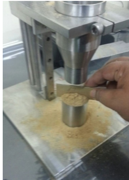
Bahan ramuan makanan formulasi diuji menggunakan alat Bulk Densitometer
