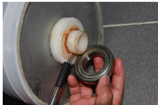
Karat yang tidak dibersihkan apabila bearing dimasukkan
