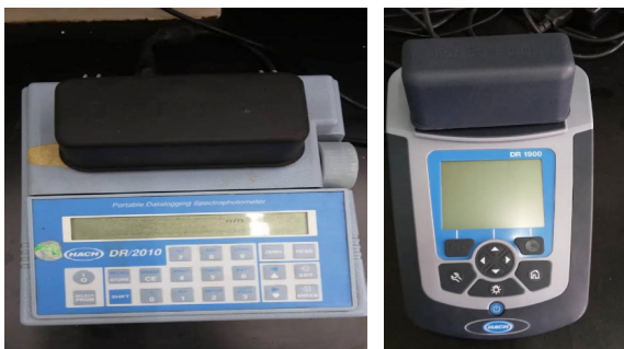
Gambar 14: Model spektrofotometer DR/2010 (kiri) dan DR 1900 yang digunakan di FRI Glami Lemi.
