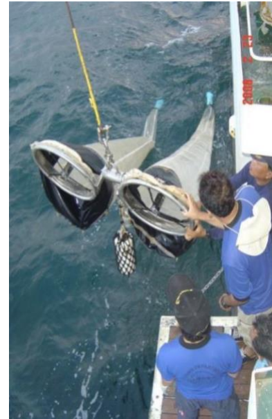
Kerja-kerja persampelan menggunakan Bongo-Net
