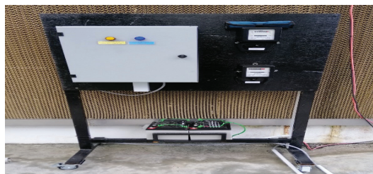
Rajah 1: Prototaip aerator berkuasa solar hibrid – elektrik yang dibangunkan
